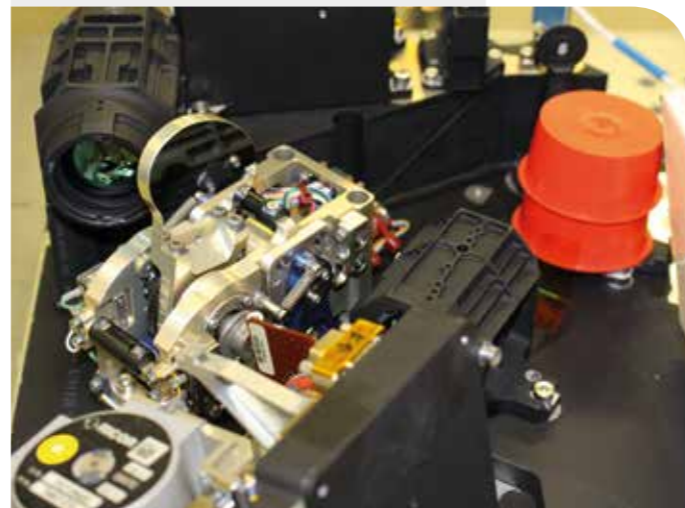
Mécanisme de miroir de NOMAD. Modèle de vol intégré dans le canal LNO.
