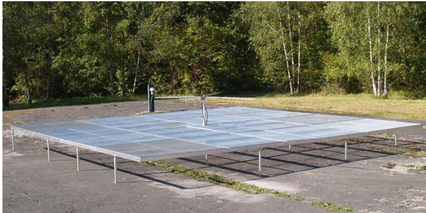
A gauche, l'antenne émettrice située à Dourbes (une antenne dipôle croisée avec une grille métallique de 8m sur 8m agissant comme plan réflecteur permettant de diriger les signaux radio plus efficacement dans l'atmosphère)
