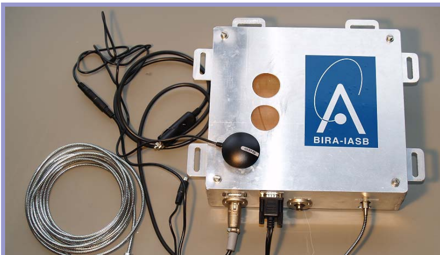
Figure 12: L'instrument ULM-DOAS avec son boîtier construit à l'atelier de mécanique de l'IASB. De la fibre optique permet de transmettre la lumière solaire à l'unité de mesure spectrométrique et un GPS est prévu pour la géolocalisation.
