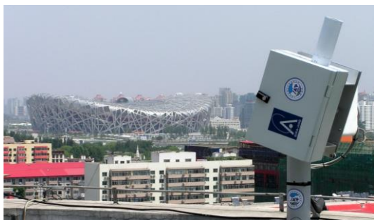
Figure 1 : photographie de la tête optique de l'instrument (MAX-DOAS), installé à Pékin.
